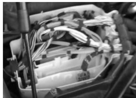
**Deckel Steuergerätekasten entfernt und Motorsteuergerät sichtbar**
