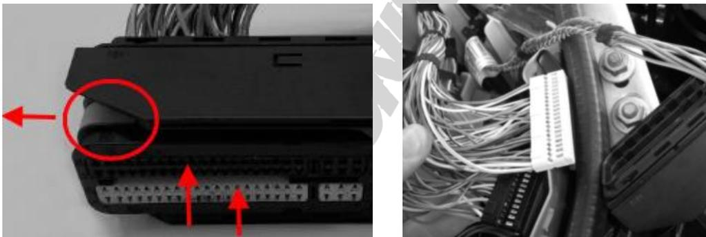
Buchsengehäuse von Steckergehäuse entriegelt und ausgebaut
