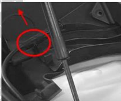
**Klammer Wasserschlauch entfernt**
